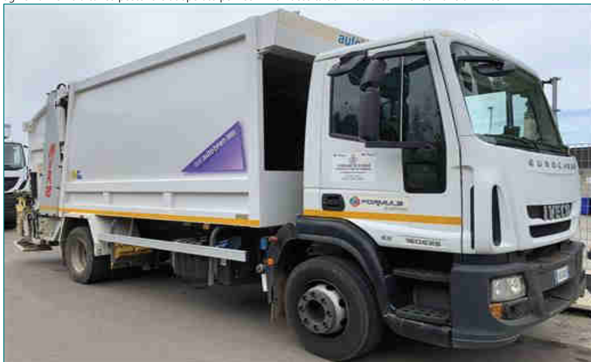
Immagine 20 Mezzo a carico posteriore adoperato per i servizi di raccolta dei rifiuti urbani nel Comune di Elmas
