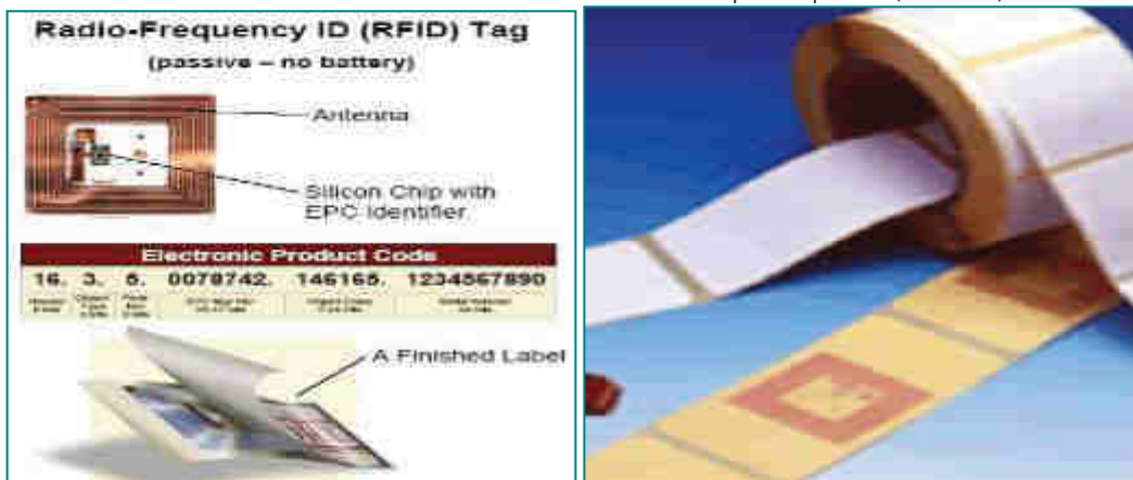
Illustrazione e schema delle etichette adesive dotate transponder passivo (RFID TAG)
