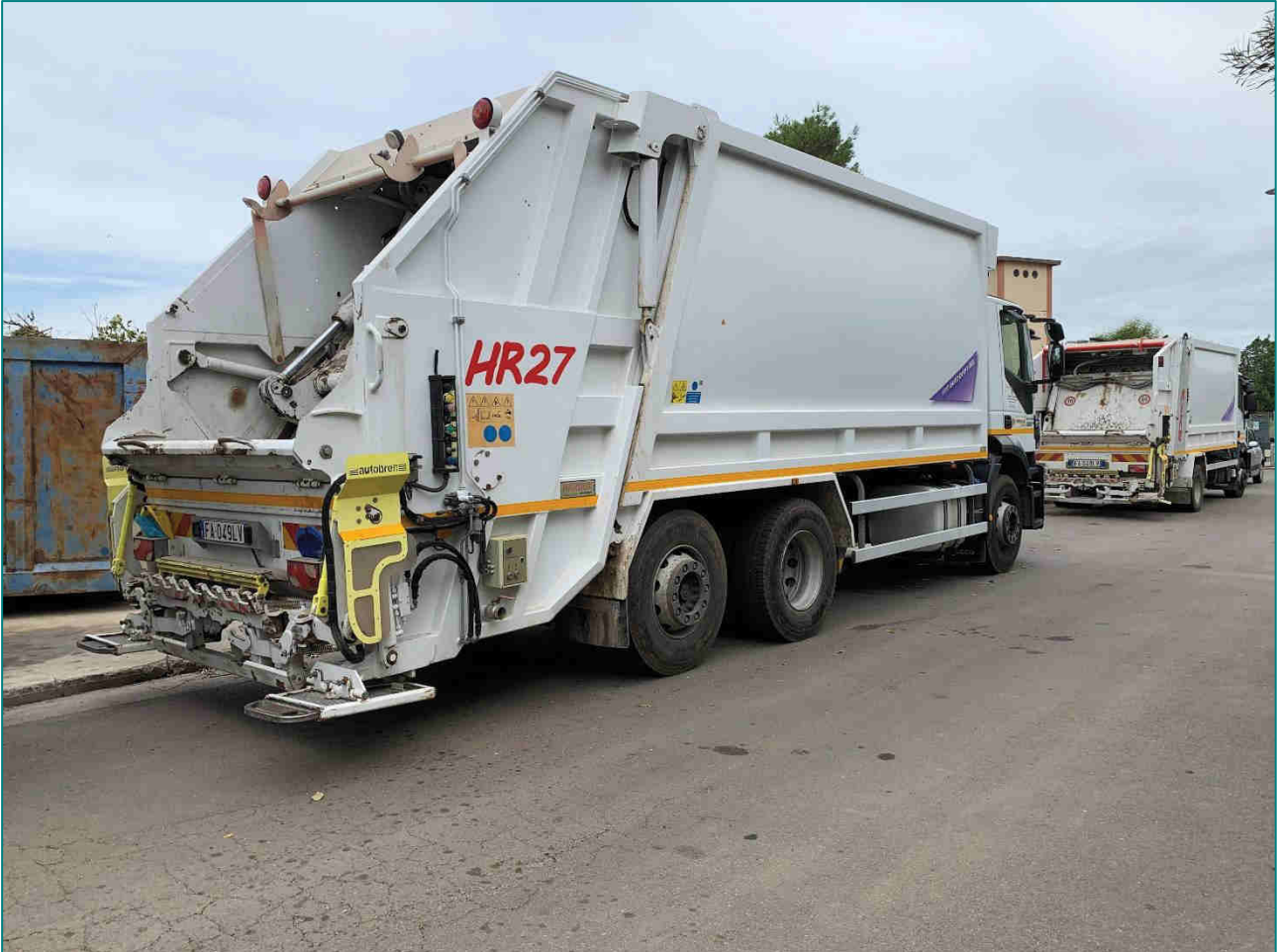
Immagine 22 Autocompattatore con carico posteriore adoperati per i servizi di raccolta nel Comune di Elmas
